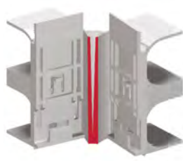
HZ vnitřní rohová objímka po instalaci (IE SCH 0002) pro vnitřní rohové tvarovky Pozor: instalujte širší stranou nahoru, protože vedení probíhá kónicky.
